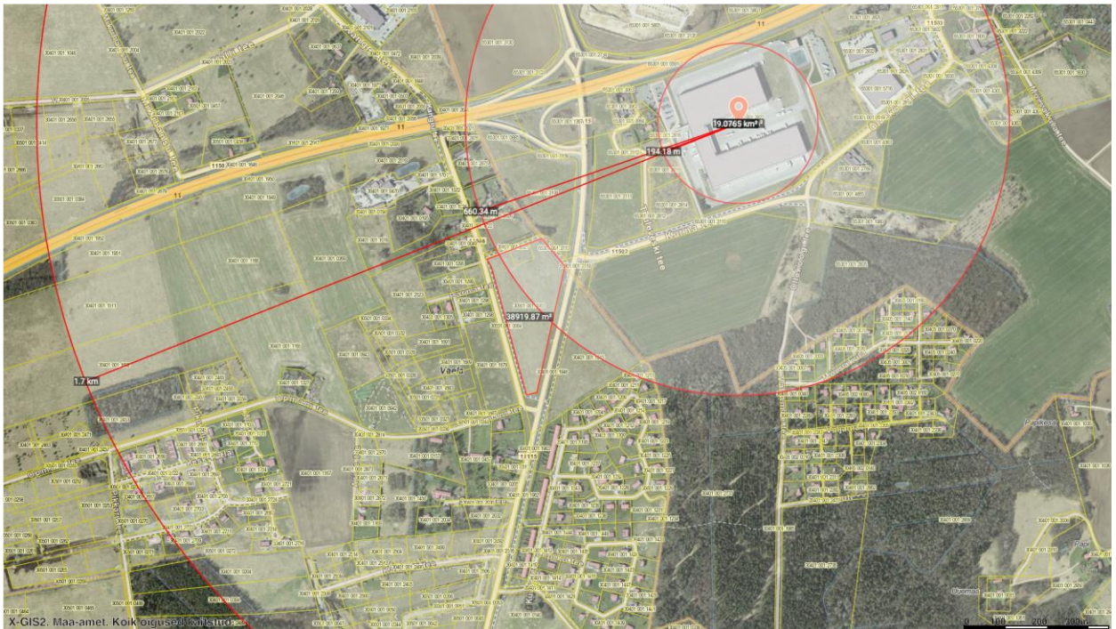
Maxima Eesti OÜ Logistikeskuse ammoniaagi lekke ohualad. (Ro: 1700 m, Rv: 660 m, Re: 194 m.) ning planeeringuala Allikas: Saare ja Tominga kinnistute detailplaneeringu alusel kavandatava lahenduse ohuhinnang (Storkson OÜ)
